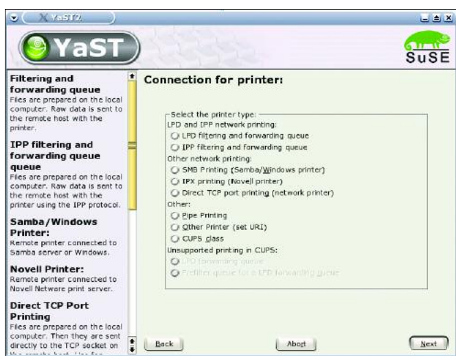
Figura 5a: Configurando uma impressora remota no Suse Linux 8.2. Primeiro, diga ao YaST que você deseja acessar uma impressora remota via IPP...
